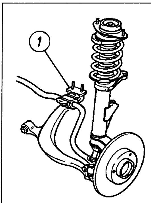
Il est autorisé de remplacer les paliers arrière d'origine (1) des bras avant par des paliers arrière triés (fournis dans le kit) - Réf. BOUTIQUE PEUGEOT SPORT : 617021-05.
