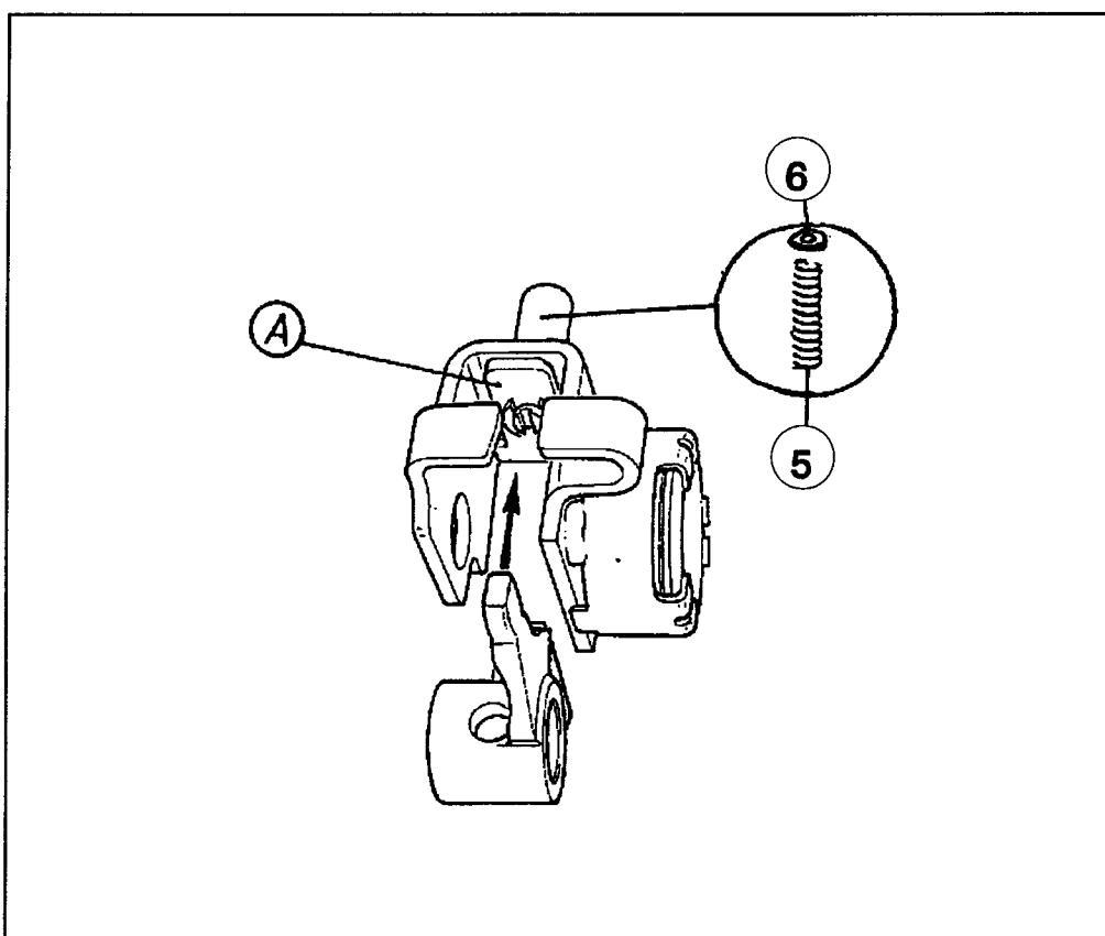
Il est autorisé de remplacer le ressort et la rondelle d'origine de la clé d'interverrouillage par un ressort (5) et une rondelle (6) triés fournis dans le kit - Réf. BOUTIQUE PEUGEOT SPORT : 82800-13 + 82800-14.
