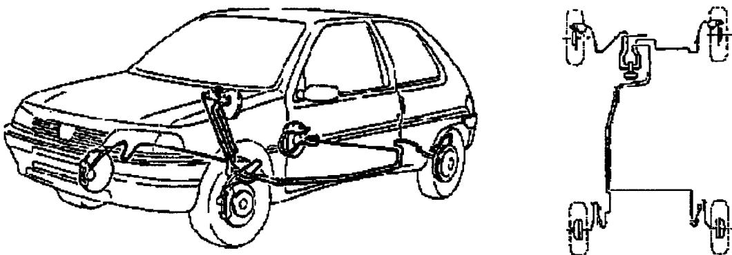
Système de freinage à double circuit en "X" avec commande par assistance à dépression.
