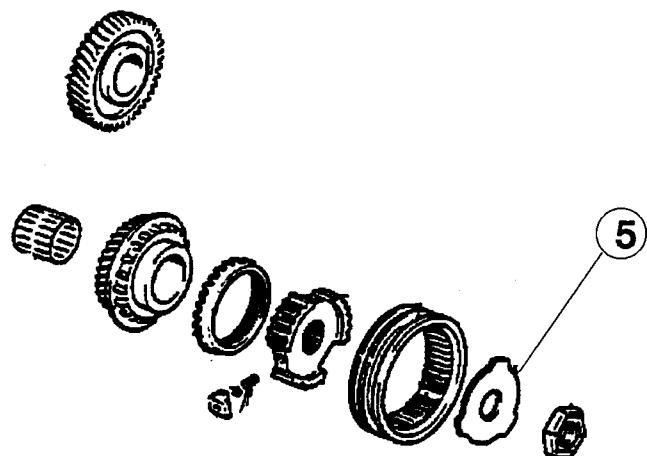
Il est autorisé de remplacer la rondelle (5) d'origine en bout d'arbre secondaire par une rondelle triée fournie dans le kit - Réf. BOUTIQUE PEUGEOT SPORT : 82810-00.
